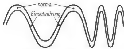
Bild 2. Änderung der Rillenbreite durch den Pincheffekt
