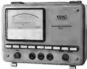
Scheinwiderstandsprüfer 1 Ω bis 1 M Ω / 800 Hz und 1000 Hz
