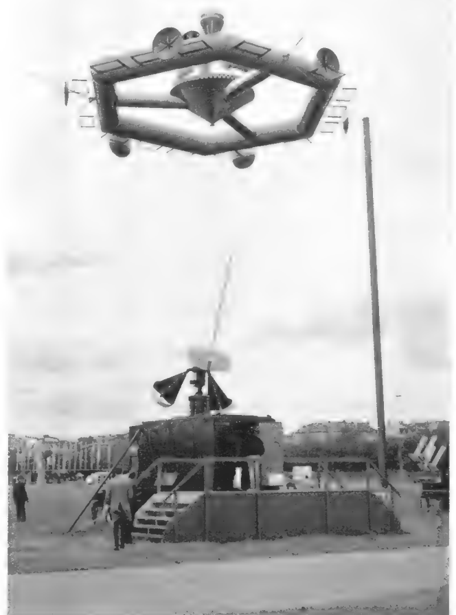
Als Wahrzeichen der IVA ist das Modell einer Weltraumstation gedacht, das hier über einer fahrbaren Wendelantenne schwebt, die zum Aufnehmen der Funksignale von Wertsatelliten dient
